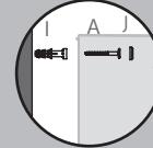
Marque na parede onde irão os furos para fixação dos armários e com a furadeira faça os furos. Coloque as buchas ("I") e fixe o armário com o acessório "A". Para finalizar utilize o acessório "J" para tampar o parafuso.
