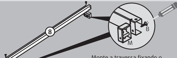
Monte a travessa fixando o acessório "M" nas pontas com o acessório "B".
