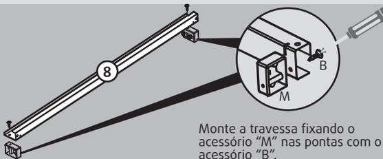
Monte a travessa fixando o acessório "M" nas pontas com o acessório "B".
